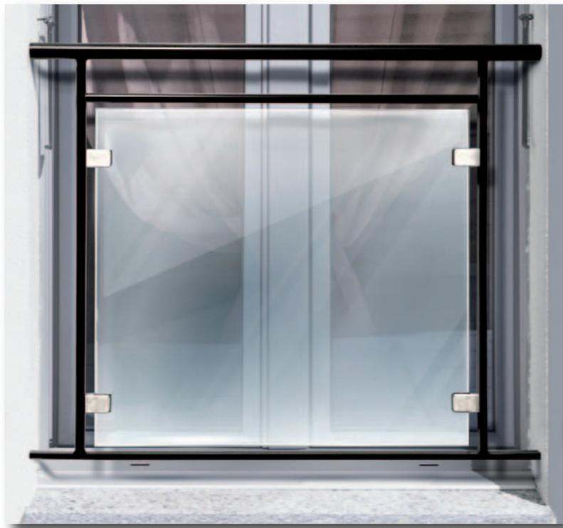
Main courante en tube rond  $\text{\O}40 \times 2$ , lisse basse et montant en fer plat  $30 \times 8$ , lisse intermédiaire en tube rond  $\text{\O}30 \times 2$ , verre feuilleté 44/2 bords polis, pince à verre en inox.
