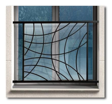
Main courante en tube rectangle 50x30x2, lisse basse en tube carré 30x30x2, motifs en carré plein 12x12, remplissage en panneau polycarbonate PPC Makrolon Incolore de 6 mm à la face arrière à insérer à la pose.
