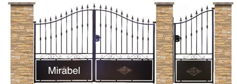
Cadre en tube 35x35x2, cintre en tube rectangle 35x20 x2, barreaudée en tube rond Ø16 avec manchon décor, frise volute en fer plat 12x5, soubassement en tôle plane de 2 mm d'épaisseur avec rosace, fer de lance de 130 mm plat de battement.
