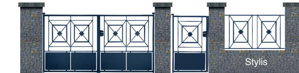
Cadre en tube 35x35x2, barreaudage en carré plein 14 et cadre intérieur fer plat 25x5, soubassement en tôle plane de 2mm, plat de battement.
